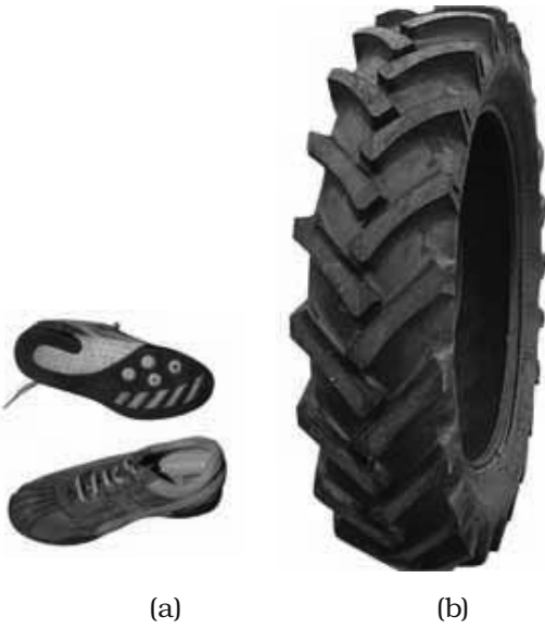
चित्र 12.11 : (a) जूते तथा (b) टायरों की तलियों को खाँचेदार बनाकर घर्षण अधिक किया जाता है।
