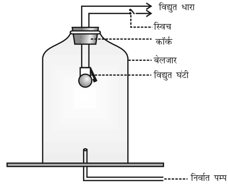
चित्र 12.6: निर्वात में ध्वनि का संचरण नहीं हो सकता यह दर्शाने के लिए बेलजार का प्रयोग
